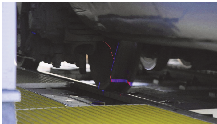
Рис. 1. Диагностический портал для инспекции поездов Pendolino
